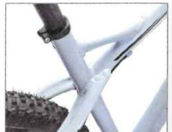
Markant: flächig geformte Streben am Sitzrohrknotenpunkt.
