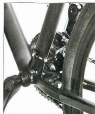
Zugführung von oben, Patronenlager, verstärkte Hinterbaugabel
