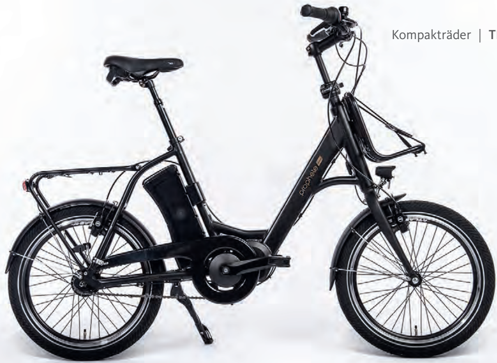
Selten: ein Mittelmotor von AEG schiebt beim Propete mit.
