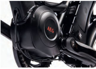
Selten: ein Mittelmotor von AEG schiebt beim Propete mit.
