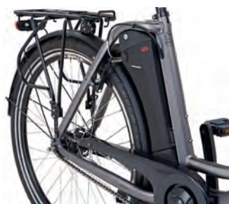
Prophete setzt beim Genießer e9.5 City auf einen Akku hinter dem Sitzrohr.
